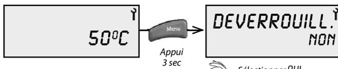
**PRO** = Verrouillage de l'accès aux menus avec déverrouillage temporaire (300 sec) possible par appui sur la touche
