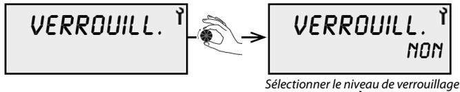
**NOM** = Le verrouillage n'est pas activé, le verrouillage manuel est cependant possible par appui sur la touche
