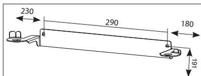
Posez l'appareil sur la traverse inférieure et appuyez-le contre le mur, tracez l'emplacement de la patte murale, retirez l'appareil.
