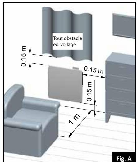
L'appareil ne doit pas être installé sous une prise de courant.
