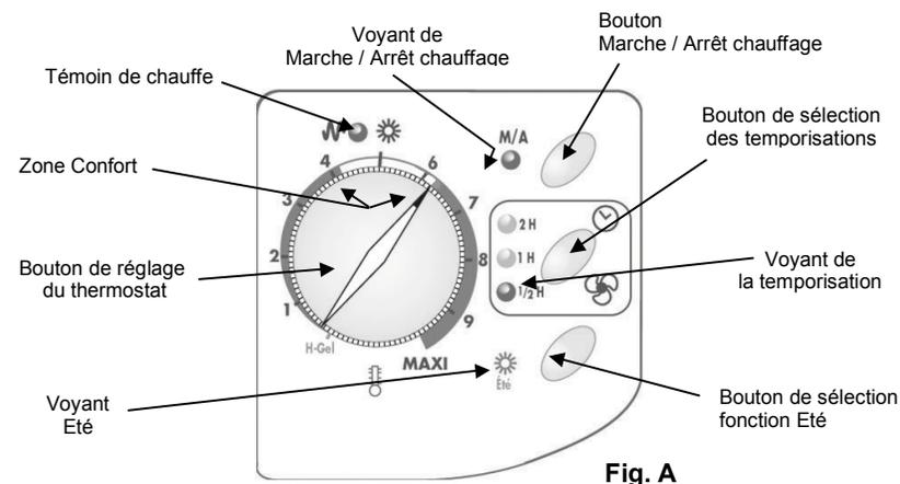
· Un thermostat d'ambiance électronique programmable : l'appareil obéit, par fil pilote, aux ordres Conf., Eco., Conf-1, Conf-2, Hors - Gel., Arrêt chauffage.
