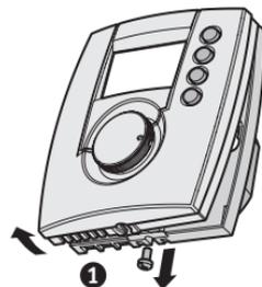
Ainsi séparé du boîtier, le socle peut être raccordé au bus, puis fixé sur une boîte d'encastrement (entraxe 60 mm).
