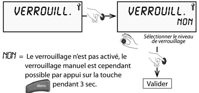
**NON** = Le verrouillage n'est pas activé, le verrouillage manuel est cependant possible par appui sur la touche
