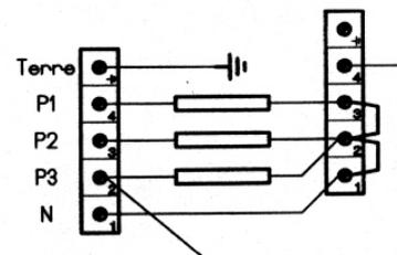
Rg Shunt à bouger pour un autre type d'alimentation par rapport au 230V mono.
